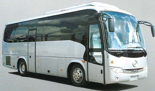
Туристический автобус Higer 6885 Пассажировместимость – 35+1 Ремни безопасности, Cummins 210 л.с., кондиционер, стеклопакет, пневмо, ABS, Webasto, Wabco
