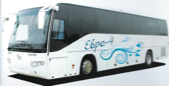
Туристический автобус Higer 6119 Пассажировместимость – 47 Ремни безопасности, Cummins 270л.с., кондиционер, стеклопакет, пневмо, ABS, Webasto, Wabco
