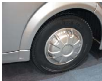
Шины отечественные, типоразмер: 245/70 R19,5. По желанию заказчика колеса можно укомплектовать фирменными колпаками
